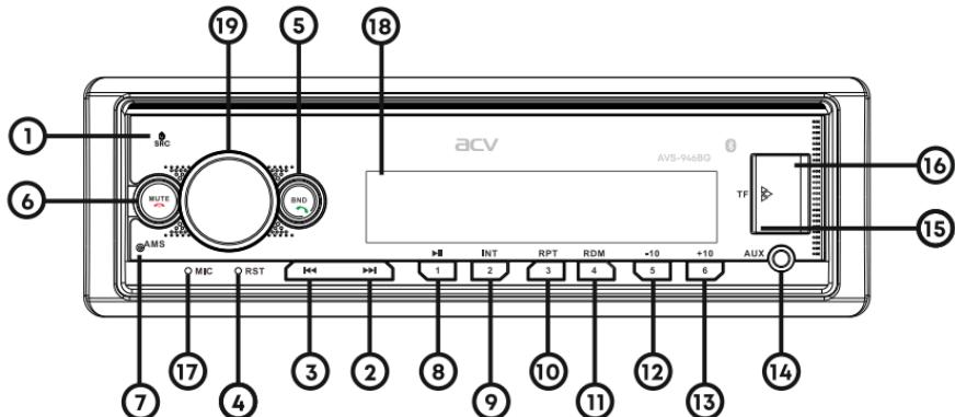
1. **/SRC** - кнопка включения/выключения устройства, выбора режимов ресивера.
