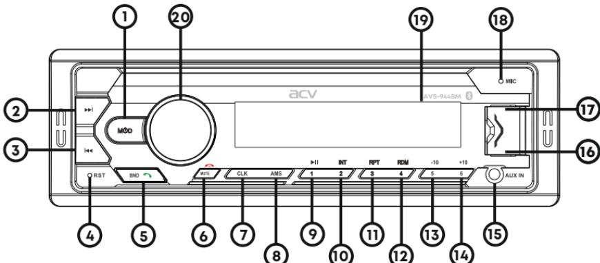
1. **⊕ /SRC** - кнопка включения/выключения устройства, выбора режимов ресивера.
