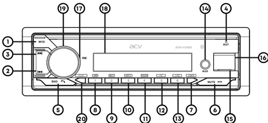
1. **МOД** - Кнопка включения/выключения устройства, выбора режимов ресивера.
