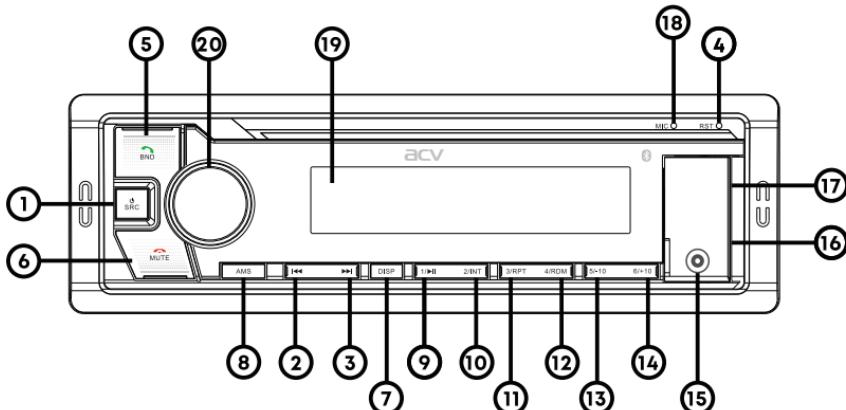
1. **⟨ / SRC** - кнопка включения/выключения устройства, выбора режимов ресивера.
